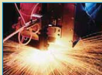
Réglage d'une sortie analogique sur la vitesse vectorielle de deux axes ; permet la régulation automatique de la puissance laser ou des processus de distribution de matière.
