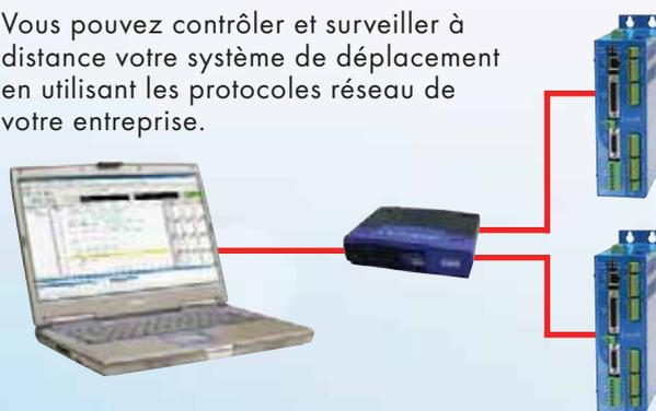
Les protocoles de communication de bus de terrain offrent de nombreuses options de communication avec les automates programmables et les autres éléments de votre système. L'architecture du réseau Aerotech de déplacement est véritablement plug-and-play, rendant l'installation simple et rapide.
